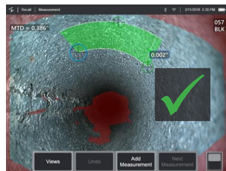
使用 3D 点云确定的正确的指针位置
