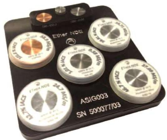
试块夹放置了电导率检测试块
